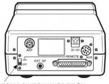
RS232 SWITCH MUST BE ON AR3000A REQUIRES MODIFICATION FOR 10.7MHz IF OUTPUT
